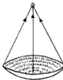
Figura 4: Principi di generazione dell'onda d'urto piezoelettrica
